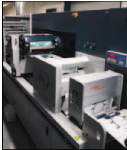
Auf der ABG Digicon 2 werden die Drucke entrollt und für den Stanz- und Prägeautomat Kama ProCut 53 vorbereitet.
